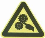
» : Attention de ne pas mettre les mains ou les vêtements sur le ventilateur, les courroies et autres pièces en rotation.
